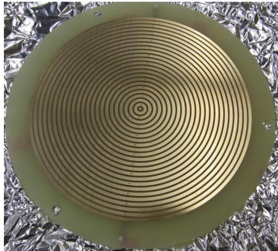
図2. 同心円状のCoplanar電極。
